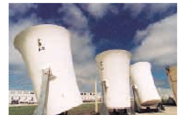
Système acoustique SODAR
