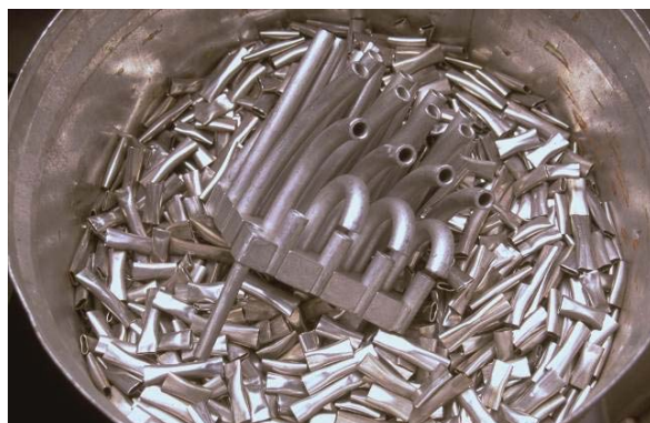
Figure 8 : Déchets de structure (coques et embouts) avant compactage
