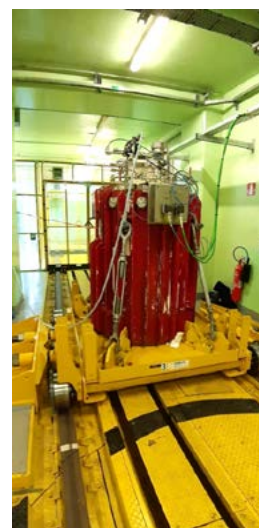
Photo 19 : colonne d'éluion du 137 Cs
