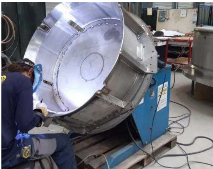
Photo 4 : modification virole panier dans les ateliers Orano Temis
