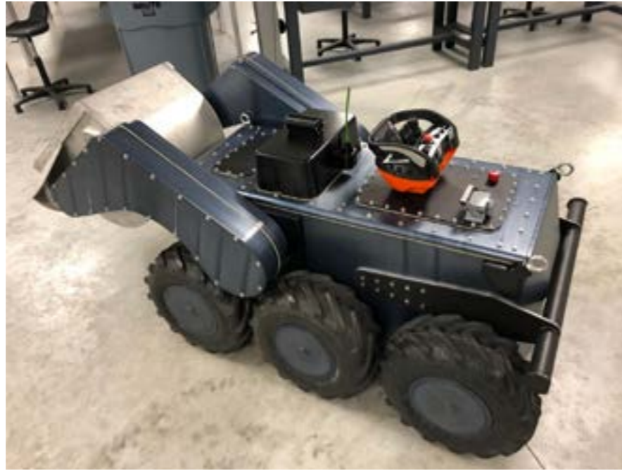
Photo 8 : prototype de robot de reprise de déchets phases 3 et 4
