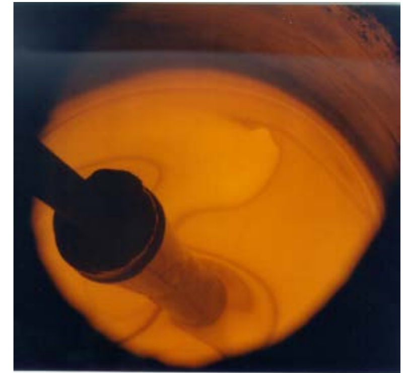
Photo 12 : verre en fusion dans le creuset froid
