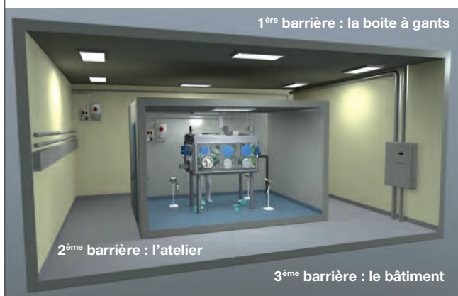
Les trois barrières de confinement de l'usine de Melox
